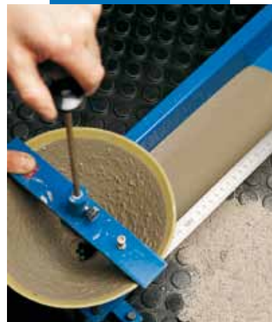
Prova di scorrimento secondo EN 13395-2
