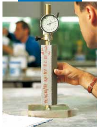
Determinazione dell'espansione contrastata secondo UNI 8147
